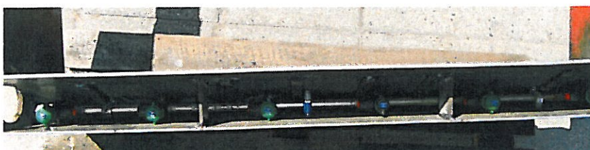
Foto 2: Sproeikoppen boven het wortelmес and afgeschermd door extra plaat.
